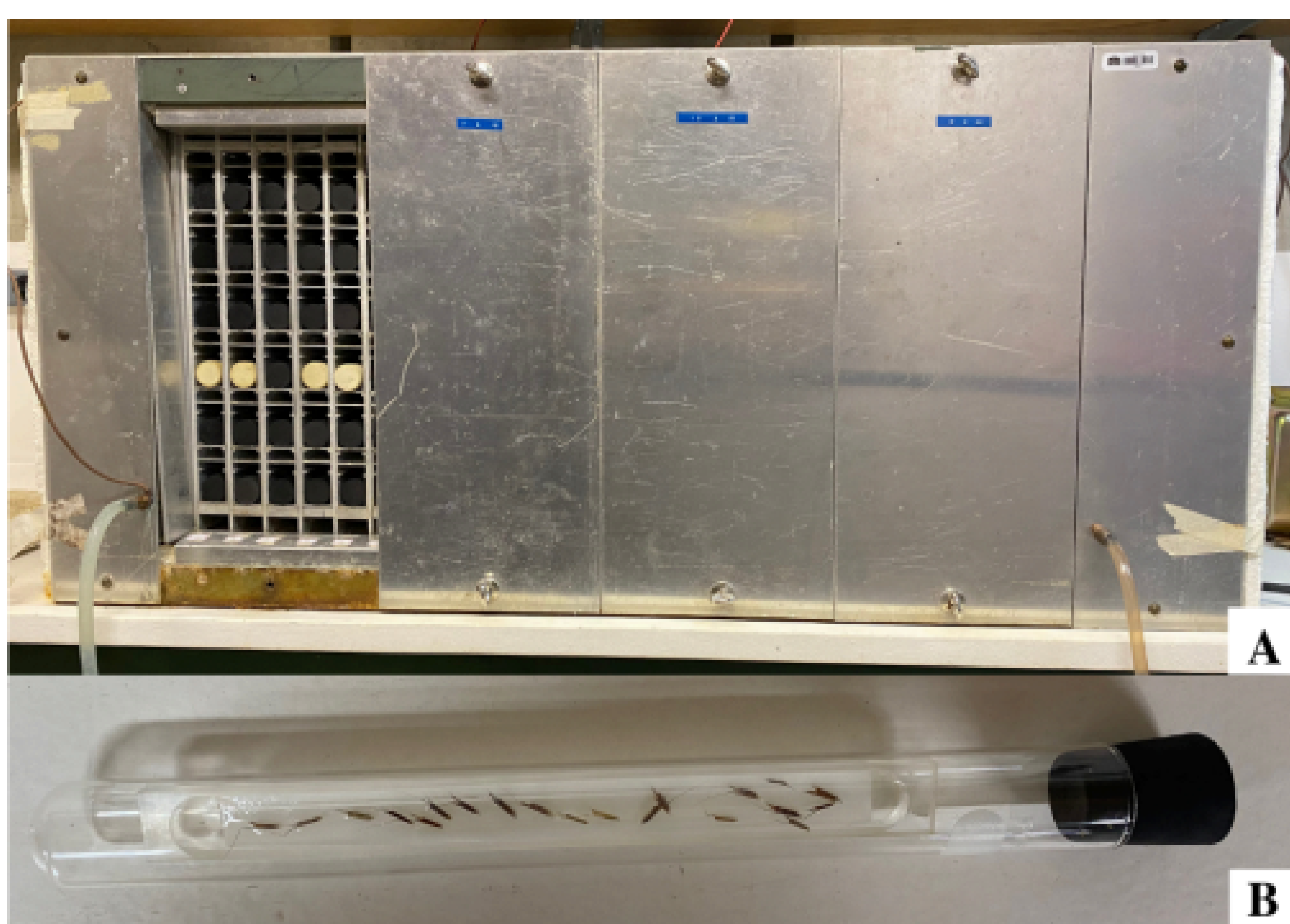
Figura 1. (A) Bloco de termogradiante, equipamento construído para avaliar efeitos de diferentes temperaturas em experimentos de germinação, em 24 colunas. (B) Tubo de vidro vedado com rolha de silicone, contendo placa onde são depositadas as sementes para experimento.
