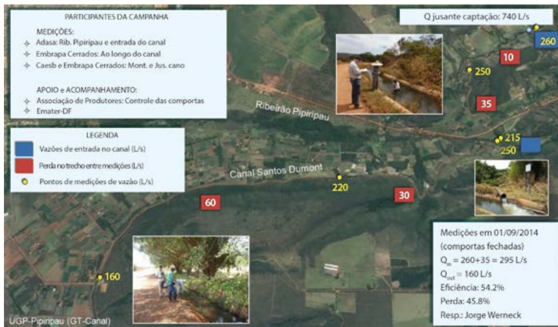
Figura 4. Fotos e resultados da campanha conjunta de monitoramento de vazões para a determinação das perdas ao longo do trecho principal do canal Santos Dumont.
